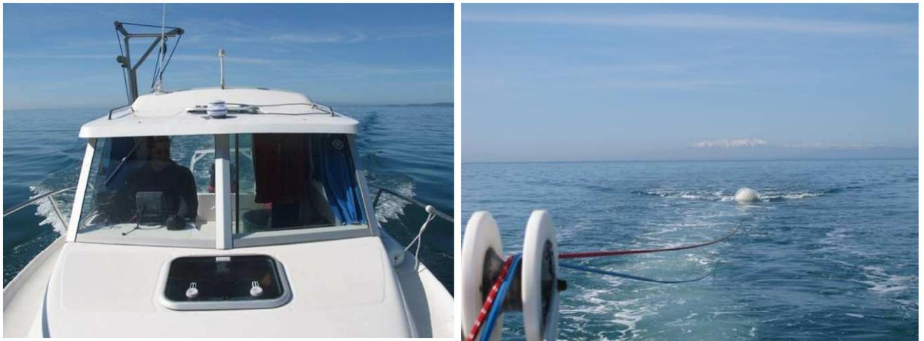
**Photo 6 : Merry Fisher avec barre de relevage en inox [1] Sonar latéral et poulie [2]**
