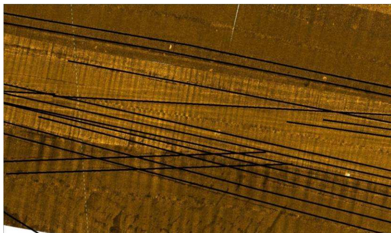
Photo 31: Matérialisation des traces de chalutage sur image sonar (Andromède Océanologie)
