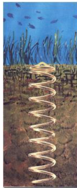
Ancre à vis (type 2) pour fixer le câble sur le fond
