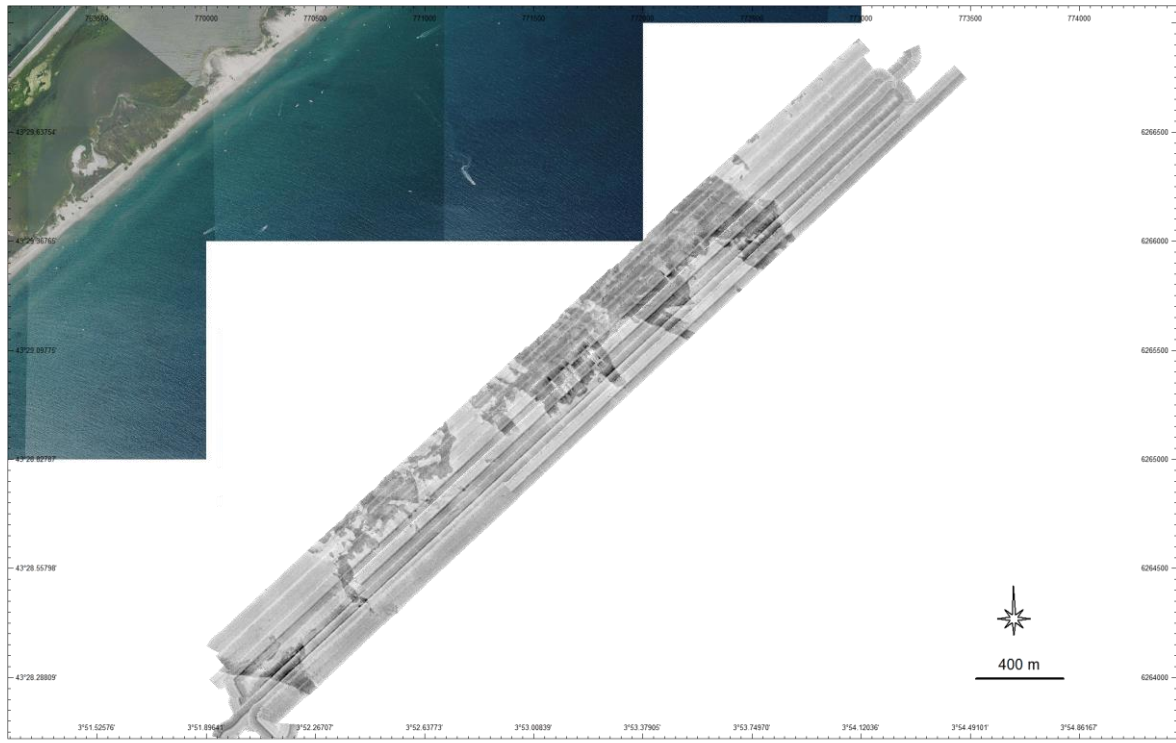
Figure 33 : Image de réflectivité du fond issue du sondeur multifaisceaux au large de Maguelone sur le site « Posidonies de la côte palavasienne ».
