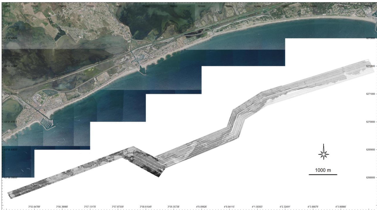
Figure 34 : Image de réflectivité du fond issue du sondeur multifaisceaux au large de Palavas sur le site « Posidonies de la côte palavasienne ».
