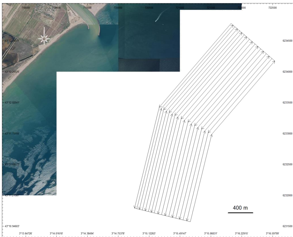
Figure 21 : Zones et trajectoires des levés au sondeur multifaisceaux sur le site « Cours inférieur de l'Aude ».
