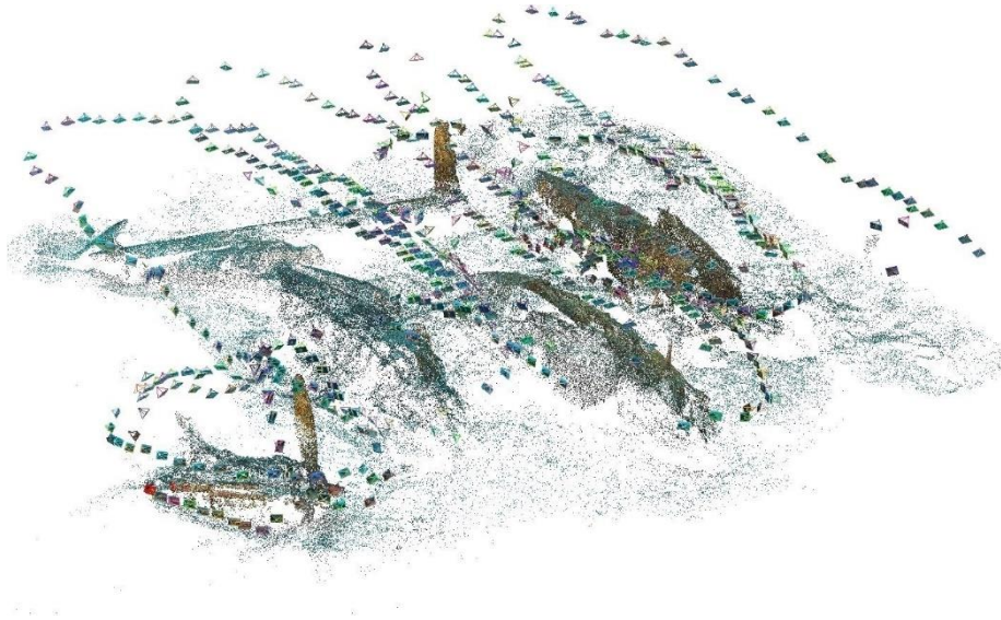
Figure 14 : Reconstitution du nuage de points de correspondance d'une épave d'avion sous VisualSFM. Le trajet parcouru durant la prise des photos est visible grâce aux miniatures des images.
