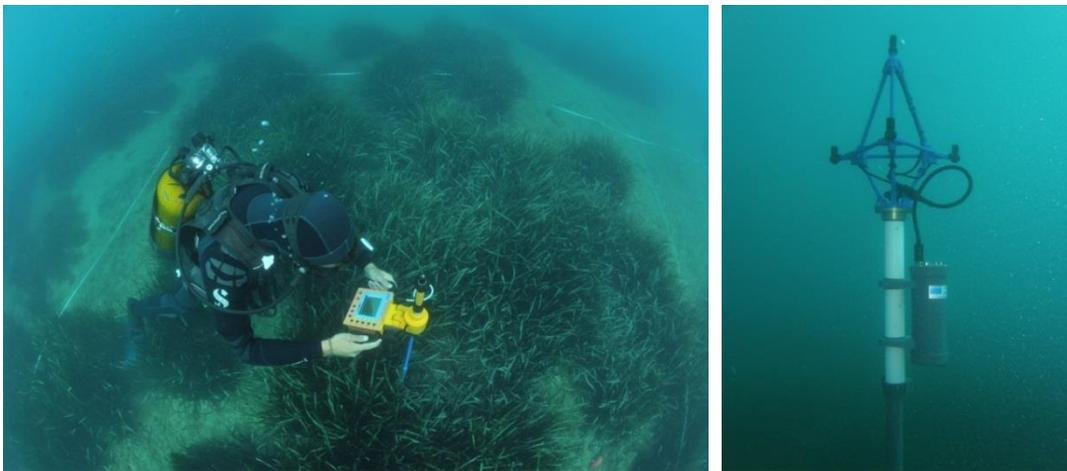
Figure 3: Plongeur opérant avec le pointeur de l'Aquamètre D100 à gauche et base de l'Aquamètre D100 à droite.
