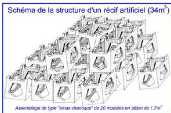
Photographie 66 : Schéma de la structure d'un récif artificiel.
