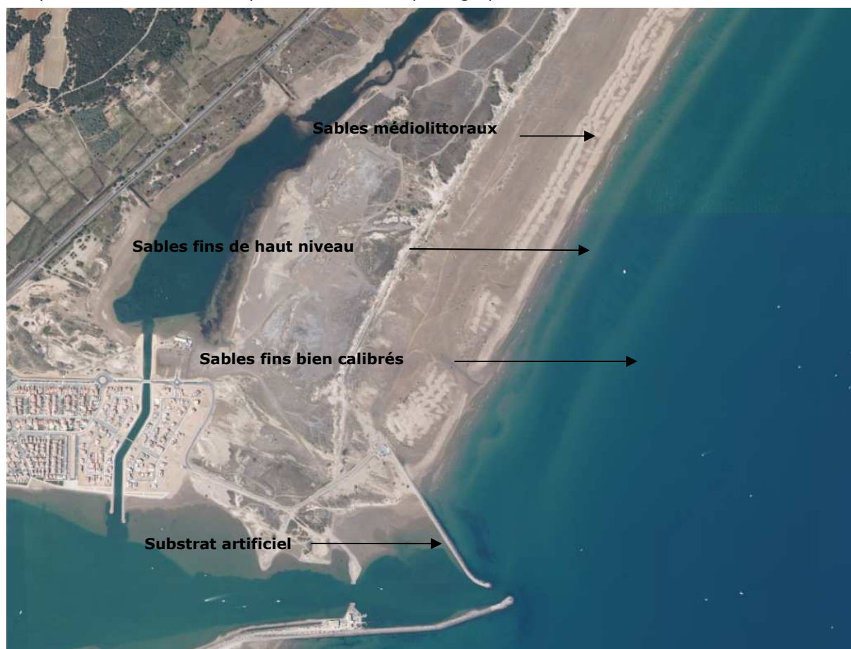
Photo 8 : Exemple d'interprétation de la photographie aérienne BD ORTHO IGN ® 2006, localisée à la sortie du port de Gruissan, pour la réalisation de la précartographie
