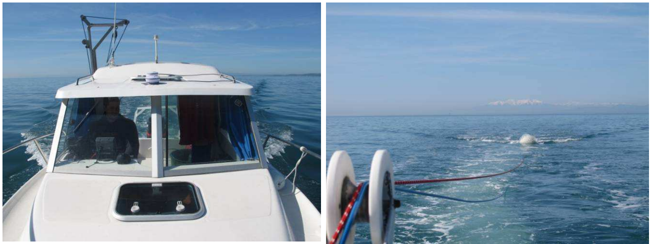
Photo 7 : Merry Fisher avec barre de relevage en inox [1] Sonar latéral et poulie [2]
