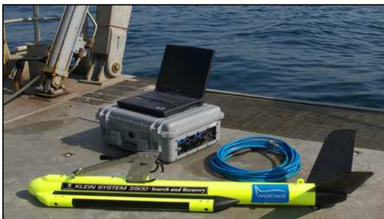
Photo 9 : Sonar Klein 3900 [1] ; Mise à l'eau du sonar [2]
