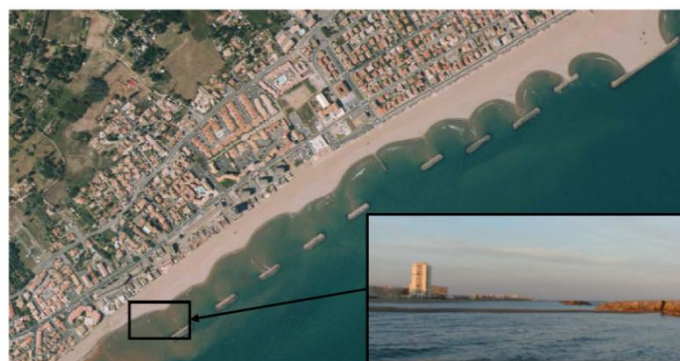
Photographie 3 : Accentuation sédimentaire derrière un enrochement artificiel de Valras-Plage constaté entre 2009 (date de la photographie aérienne) et 2012 (date de la photographie de vérité terrain)
